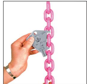
Bilder 5.40a bis c: Der Kennzeichnungsanhänger bei den Ketten der Firma RUD dient als Prüfschablone, um die Verschleißgrenze festzustellen.
