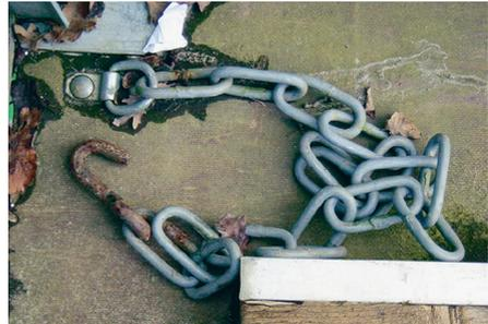
*Bild 5.36: Selbstgebauter Kettenhaken. Die Kette ist langgliedrig und als Ladungssicherungskette nicht zugelassen. Der Anschlagpunkt am Pkw-Anhänger ist lediglich mit einer 12 mm Schlossschraube versehen, die durch den Holzboden des Fahrzeugs geschraubt wurde.*
